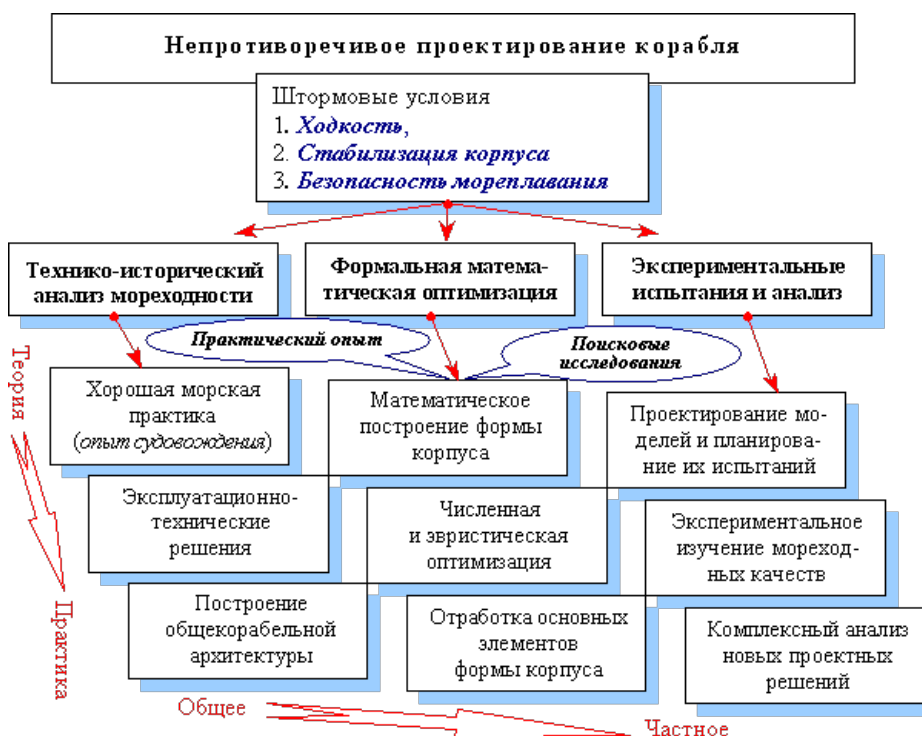
Схема 1. Логическая схема проектного этапа изучения штормовой мореходности.
